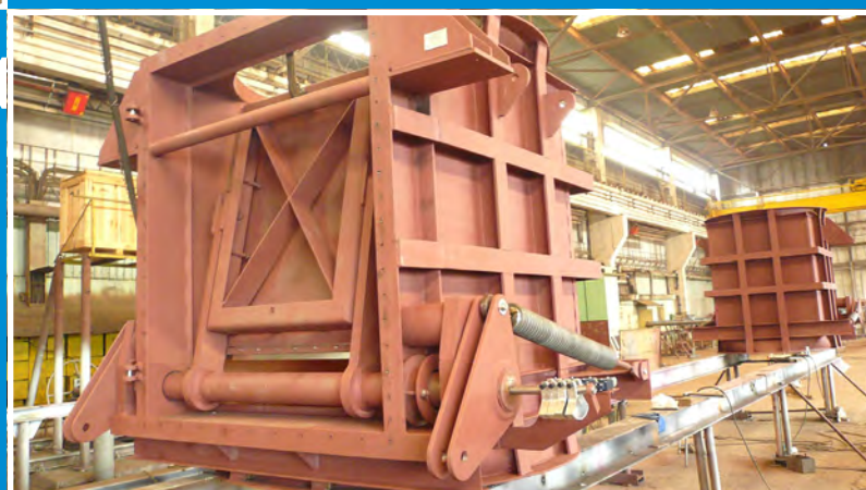
Mehldau & Steinfahrt, Wesseling Control damper type L Material S235JR Dimension lw. Ø 800 2012
